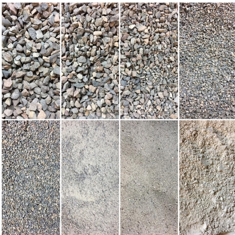
Figura 1. Áridos vírgenes empleados (parte superior; grava triturada 6-19 fraccionada, parte inferior; arena triturada 0-6 fraccionada, arena de zaranda, carbonato de calcio)
