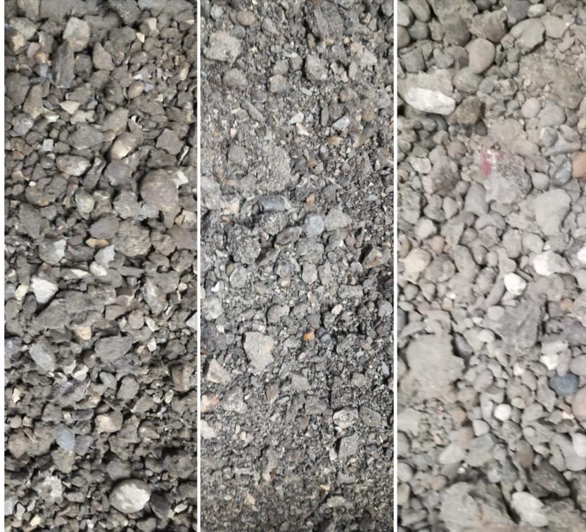
Figura 2. Materiales de fresado (izquierda a derecha; RAP-00, RAP-01 y RAP-02)
