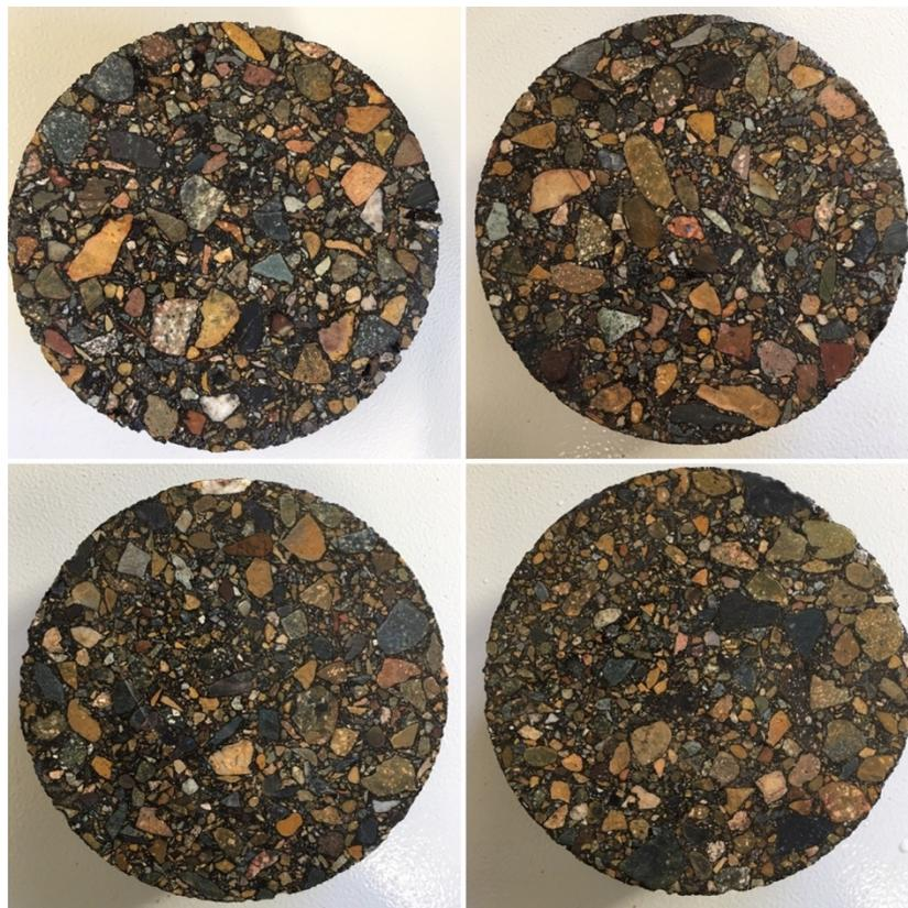
Figura 14. Distribución granular en el seno de las muestras confeccionadas en laboratorio (izquierda a derecha; parte superior; mezcla patrón, mezcla con 25% de RAP, parte inferior; mezcla con 50% y 75% de RAP)
