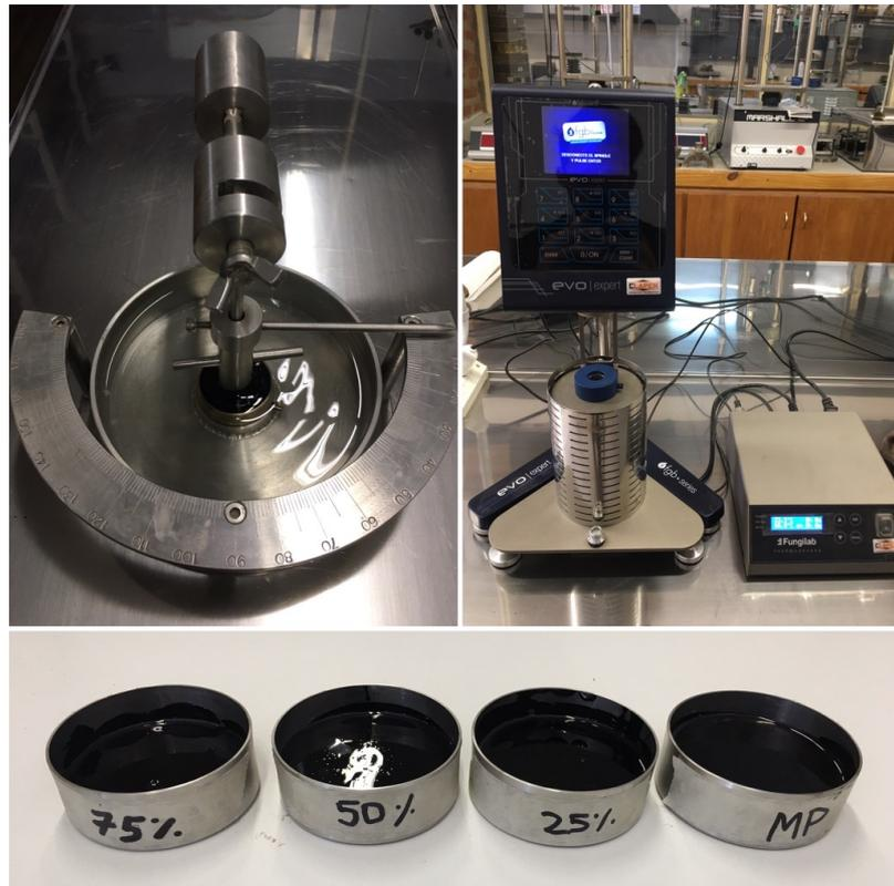
Figura 7. Análisis reológico de la combinación de asfaltos (parte superior izquierda; ensayo de recuperación elástica torsional, derecha; ensayo de viscosidad Brookfield, parte inferior; muestras de asfaltos combinados)
